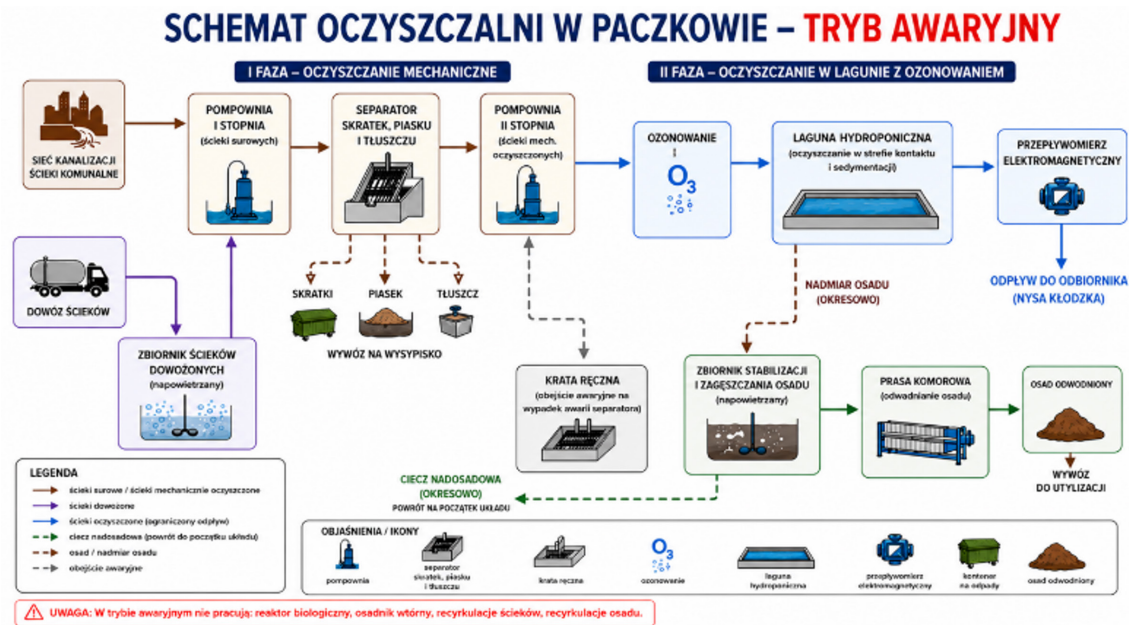
Rys. 4. Schemat technologiczny oczyszczania ścieków w trybie awaryjnym (ZWIK Paczków) Fig. 4. Technological diagram of wastewater treatment in emergency mode (ZWIK Paczków)
