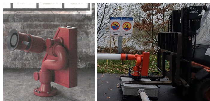
Rys. 1. Badane działko wodno-pianowe w pomieszczeniu zamkniętym (po lewej) oraz na stanowisku poligonowym (po prawej) Źródło: opracowanie własne
