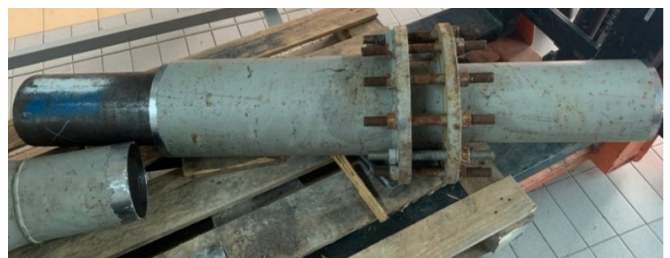
Rys. 1. Obiekt badany nr 1: Kompensator DN150 PN16
