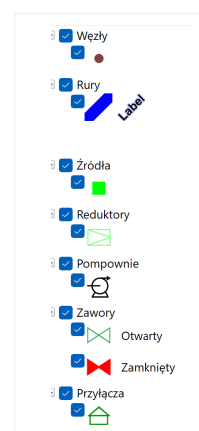
Rys. 2. Symbole graficzne elementów sieci
